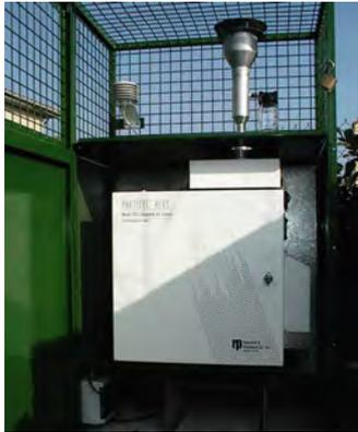
Type d'appareil utilisé : Partisol Plus (photo ci-contre)
