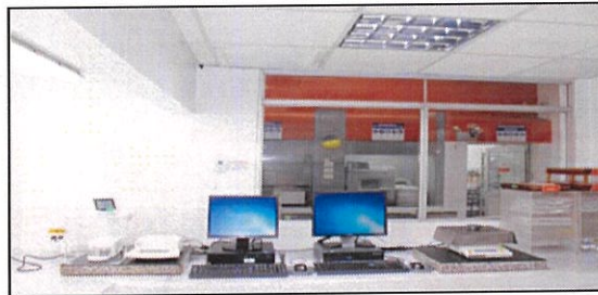
Fotografía N° 1 Sala de pesaje de filtros con control de humedad y temperatura
