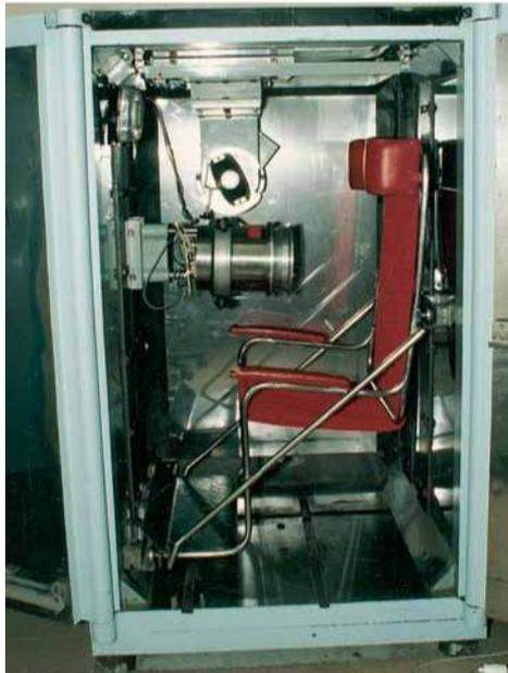
*Installation d'anthropogammamétrie en place sur l'atoll de Mururoa montrant une sonde NaI dans une enceinte blindée.*
